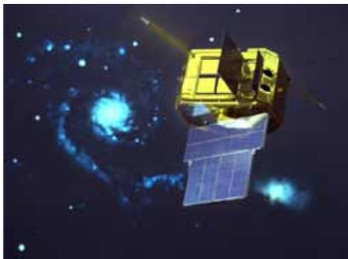
1983: Erster Röntgensatellit der ESA EXOSAT: Durch hohen Orbit (190000km Erdferne) lange Beobachtungszeiten von bis zu 76h
