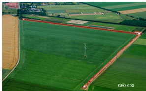
Abbildung: geo-600 Hannover, 600m Armlänge 10kW Lichtleistung durch duales Recycling (100-fache Verstärkung)
